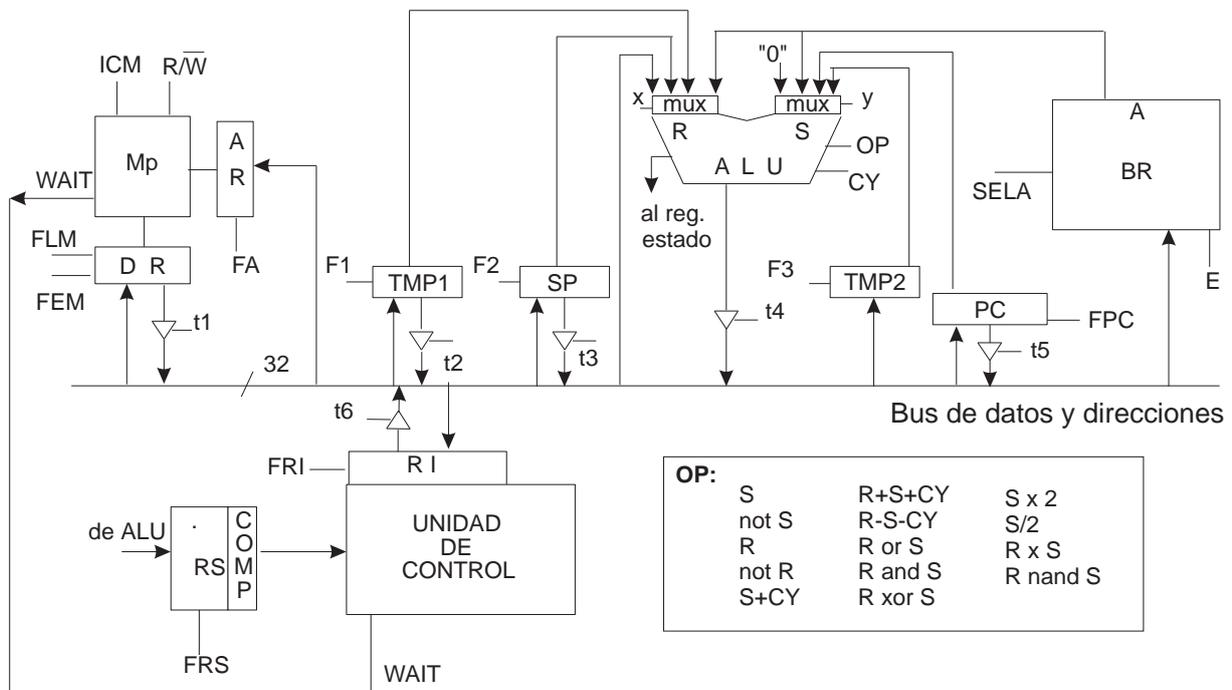
Figura 4. Estructura de la CPU y operaciones de la ALU
