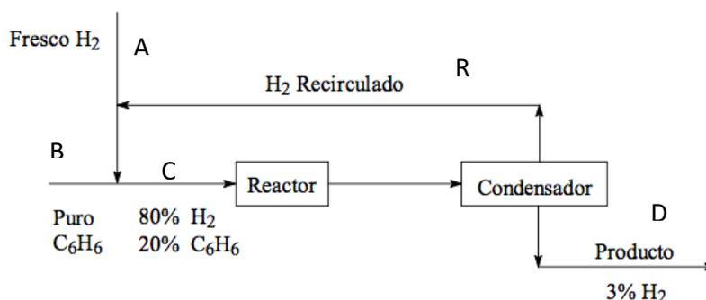
**Solución:** Benceno alimentado=101,0 kmol/h; H<sub>2</sub> fresco alimentado=303,12 kmol/h; Relación de recirculación (H<sub>2</sub>) =0,33
