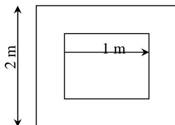
La temperatura de la pared exterior es 100°C y la de la pared interior 1000°C. La conductividad térmica de la pared puede considerarse igual a 0,5 kcal/h.m<sup>2</sup>.°C/m.
