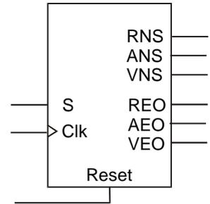
Partiendo de una señal de reloj de periodo 5 s, se pide dibujar el diagrama de estados de una máquina Moore que controle el sistema. Considere que las luces se encienden con "1".
