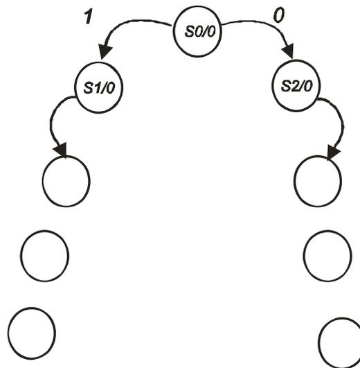
**Problema 16:** Una FSM Mealy tiene una entrada de datos serie X sincronizada con una señal de reloj CLK. La salida tiene dos bits Z1Z0. El circuito parte de Z1Z0=0 y cambia a Z1Z0=10 si detecta la secuencia 0101. Del mismo modo, pasa a Z1Z0=11 cuando detecta la secuencia 1110. Se pide completar el diagrama de estado adjunto considerando que la máquina debe volver al estado inicial So con el pulso de reloj que detecta cualquiera de las dos secuencias correctas.
