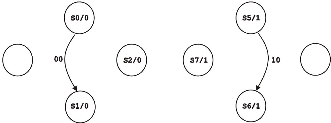
**Problema 15:** Una FSM Moore debe detectar que se recibe 0110 ó 1001, en una secuencia de datos formada por paquetes de 4 bits SIN SOLAPAMIENTO. La máquina debe poner la salida Z a uno cada vez que reciba el último de los 4 bits de cada secuencia correcta. Se pide completar el diagrama de estados de figura. Agregue lo que necesite o deje sin usar lo que no le haga falta.
