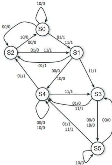
**Problema 27:** Diseñar una FSM que detecte en una transmisión serie sincronizada con una señal de reloj, la siguientes secuencias: 1111 ó 11011 con solapamiento. Se pide sólo completar el diagrama de estados adjunto, correspondiente a un modelo Moore.
