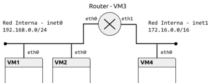
Todos los elementos -el router y las máquinas virtuales VM- son *clones enlazados* de la máquina base ASOR-FE. La configuración de las máquinas se realizará con la utilidad `vtopo1`, que funciona en Linux y Mac (en Windows, la topología ha de crearse directamente con VirtualBox):
