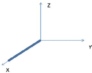
Por un cable de 1 m de longitud y 100 g de masa pasa una corriente de 4 A en el sentido positivo del eje X. Se produce un campo magnético de módulo  $B = 0.1$  T en el sentido positivo del eje Y. (a) Hallar el módulo, la dirección y el sentido de la fuerza que dicho campo ejerce sobre el cable. (b) Si se quiere compensar el peso del cable, qué módulo y sentido tiene que tener el campo en el eje Y?
