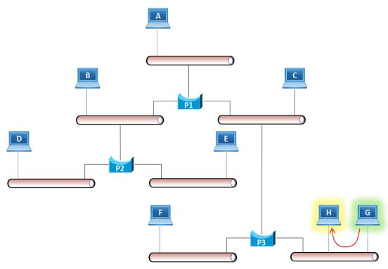
Dado que el puente P3 ya tiene incorporada en sus tablas de aprendizaje la dirección MAC del Host H, esta segunda trama enviada a H solo se difundirá en sus segmento, por lo que llegará solo al puente local 3 y al host H.
