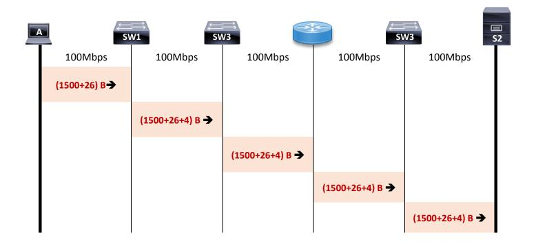
$$T_{\text{transmisión}} = \frac{(1500 + 26)B \times 8\frac{b}{B}}{10^{8}\frac{b}{s}} + 4 \times \frac{(1500 + 26 + 4)B \times 8\frac{b}{B}}{10^{8}\frac{b}{s}}$$
