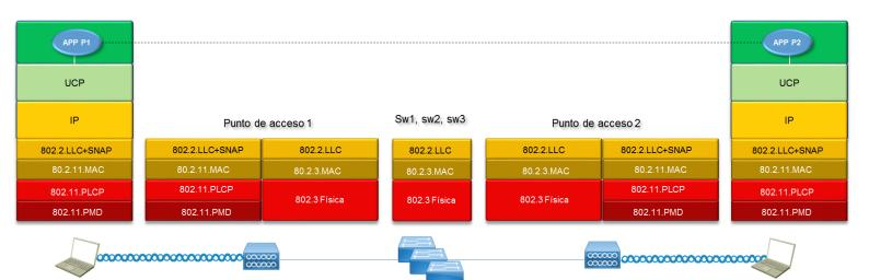
El Subnetwork Access Protocol (SNAP) es un protocolo recogido por la norma IEEE 802 que permite direccionar diferentes protocolos utilizando un SAP o Punto de Acceso al Servicio (Interfaz física a través de los cuales los niveles de orden más bajo en el modelo OSI proveen servicios a los de mayor orden) público.
