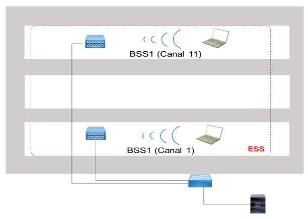
La empresa planea ampliar el espacio de trabajo debido al alquiler de la segunda planta. Por lo tanto, el ESS se amplía con un punto de acceso adicional en el segundo piso.
