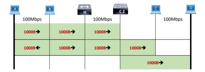
Nótese que el hub recibe las tramas transmitidas por A y B, sin embargo la trama trasmitida por C2 hacia C no llega a D, y la que transmite a D no es recibida por C.
