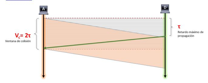
L=Longitud mínima de la trama; **T** = tiempo de propagación; Tt=Tiempo transmisión
