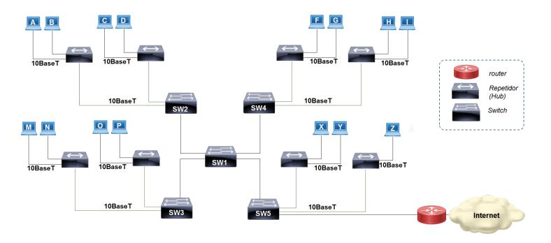
Donde los conmutadores Ethernet son de 4 puertas cada uno. Todas las puertas de los conmutadores funcionan según la norma 10BaseT. El tiempo de proceso de cada Conmutador es de 40 microsegundos. Los Conmutadores funcionan mediante almacenamiento y envío.
