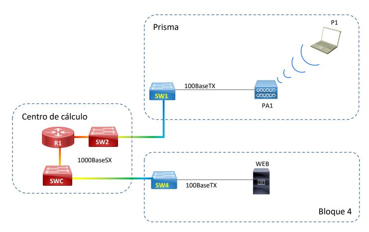
Los datagramas del portátil P1 autorizados por el router R1 son encaminados a la red cableada, en este caso a un conmutador de cabecera (SWC) situado en el BLOQUE I y luego por una fibra 1000BASE-SX a un conmutador del BLOQUE IV
