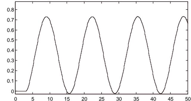
Con esta información determinar los parámetros del controlador PID sintonizados por el método de Ziegler-Nichols, encontrar la función de transferencia del lazo cerrado, y analizar la estabilidad y el error en estado estacionario del sistema.
