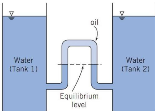
2.- En una determinada situación, desean vigilarse las diferencias de nivel de agua (de densidad  $\rho=10^3 \text{ kg/m}^3$ ) entre dos grandes depósitos, para lo cual se unen con una tubería de vidrio que contiene un aceite de densidad  $\rho'$ , según se indica en la figura. ¿Cuál es la densidad de ese aceite si la diferencia de nivel entre las interfases agua-aceite de la tubería amplifican 10 veces la diferencia de nivel entre los depósitos?
