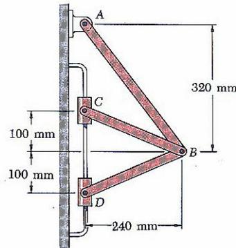
$$\left. \begin{aligned} \vec{v}_B &= \vec{v}_C + \vec{v}_{BC} \\ \vec{v}_B &= \vec{v}_A + \vec{v}_{BA} \end{aligned} \right\} \Rightarrow \vec{v}_C + \vec{v}_{BC} = \vec{v}_{BA} \Rightarrow -0,66 \cdot \vec{j} + \begin{vmatrix} \vec{i} & \vec{j} & \vec{k} \\ 0 & 0 & \omega_3 \\ 0,24 & -0,10 & 0 \end{vmatrix} = \begin{vmatrix} \vec{i} & \vec{j} & \vec{k} \\ 0 & 0 & \omega_2 \\ 0,24 & -0,32 & 0 \end{vmatrix}$$
