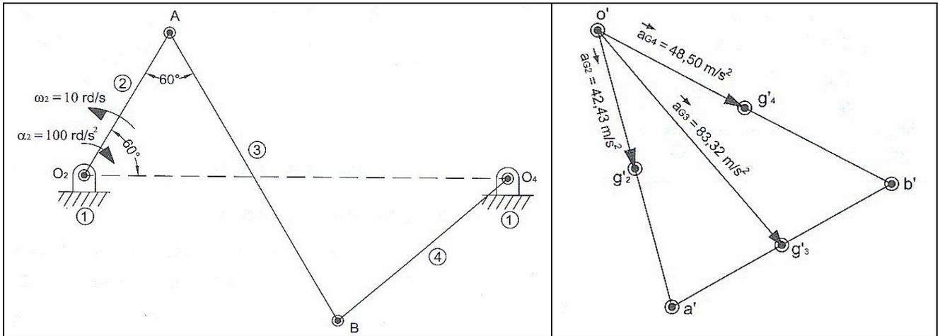
$O_2A = 60 \text{ cm}$ ,  $AB = 120 \text{ cm}$ ,  $O_2O_4 = 150 \text{ cm}$ ,  $m_2 = 0.500 \text{ kg}$ ,  $m_3 = 0,742 \text{ kg}$ ,  $m_4 = 0,600 \text{ kg}$ ,  $I_{G_2} = 0,062 \text{ kg}\cdot\text{m}^2$ ,  $I_{G_3} = 0,172 \text{ kg}\cdot\text{m}^2$ ,  $I_{G_4} = 0,108 \text{ kg}\cdot\text{m}^2$ ,  $\alpha_3 = 61,54 \text{ rad/s}^2$ (antihorario),  $\alpha_4 = 113,85 \text{ rad/s}^2$ (horario).
