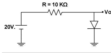
8. Calcular la corriente de saturación  $I_S$  de un diodo de silicio de baja potencia a temperatura ambiente con los datos proporcionados a continuación. Encontrar también la tensión directa aplicada  $V$  cuando la corriente total es,  $I = 1 \text{ mA}$ .
