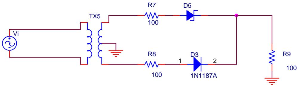
Nota – El transformador proporciona la señal de entrada dividida por 10 en el terminal de arriba y desfasada  $180^\circ$  en el de abajo
