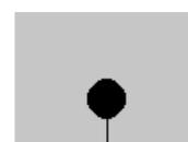
3- Un cable anclado en el fondo de un lago sostiene una esfera hueca de plástico bajo la superficie. EL volumen de la esfera es de  $0.3 \text{ m}^3$  y la tensión del cable  $900 \text{ N}$ . Calcular la masa de la esfera. Si el cable se rompe, la esfera sube a la superficie. Cuando está el equilibrio, ¿Qué fracción de volumen de la esfera estará sumergida? Dato: densidad del agua de mar:  $1.03 \text{ gr/cm}^3$
