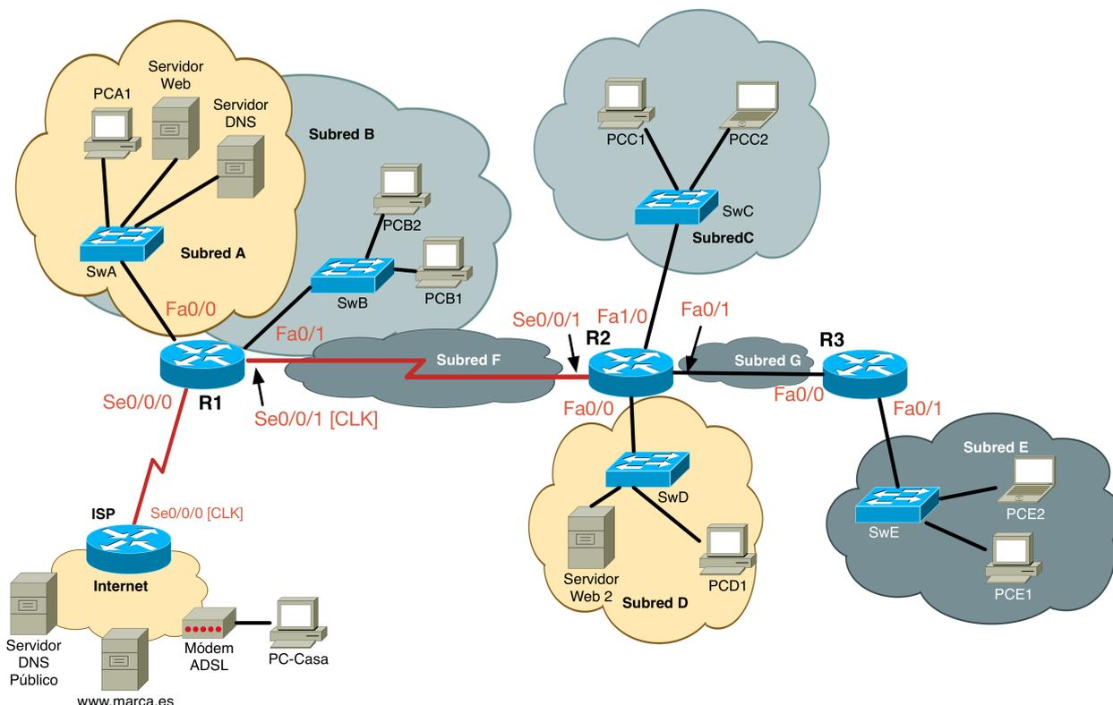
Nótese que la parte de Internet se simulará conectando equipos directamente a interfaces del router ISP a través de cables Ethernet cruzados.
