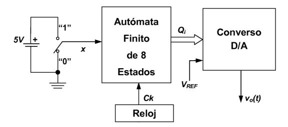
**DESCRIPCIÓN DEL SISTEMA:** El sistema consiste en un Autómata Finito (AF) de 8 estados, cada uno de los cuales da lugar a un nivel de tensión analógica en la salida del sistema que coincide con la del Conversor D/A,  $v_o(t)$ .
