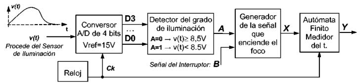
El sistema consta de un sensor de iluminación que genera una señal analógica, v(t), cuya amplitud está comprendida entre 0V y 15V y que depende de la iluminación ambiental. Esta señal se convierte a palabras digitales de 4 bits (**D3 D2 D1 D0**) y mediante un detector de umbral se genera una señal **A**. Esta señal, **A**, junto con la señal procedente de un interruptor que se activa manualmente, **B**, dan lugar a la señal que apaga y enciende al foco, **X**.
