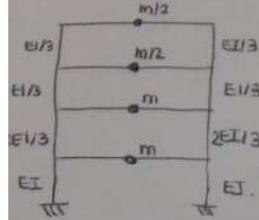
• obtener las matrices de masa  $[M]$  y  $[K]$  mediante los coef. de influencia. Justifícan y apoyan con gráficos.
