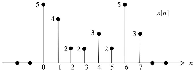
la cual ha sido obtenida mediante muestreo de  $T=1/100$  segundos y enventanado de una señal continua de tal forma que  $x[n]$  coincide exactamente con las primeras 8 muestras de la señal discreta, se desea calcular su DFT de 8 puntos,  $X[k] = DFT_8\{x[n]\}$ .
