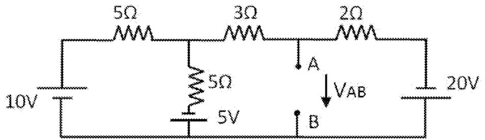
7. Sea el circuito de la figura en donde el interruptor ha permanecido cerrado suficiente tiempo como para haber alcanzado el régimen permanente. Si en  $t=0$  se abre el interruptor, calcular el módulo de la tensión entre los bornes del interruptor para  $t=10ms$ .
