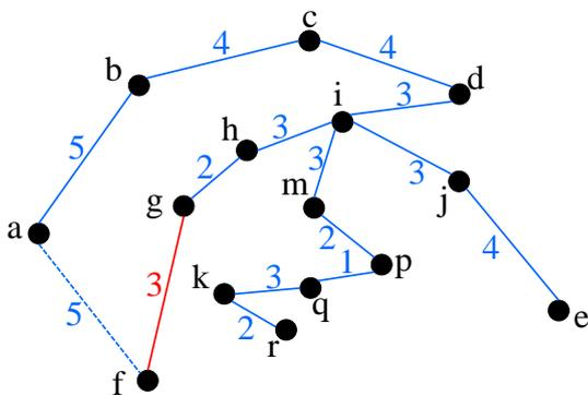
La solución óptima se obtiene ensanchando las carreteras correspondientes a un árbol recubridor de peso mínimo. Usando el algoritmo de Kruskal se obtiene el árbol anterior (aristas azules) que tiene peso  $w(T) = 44$ . Luego el valor de la partida presupuestaria debe ser 44 millones de euros.
