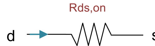
Circuito equivalente en conducción
