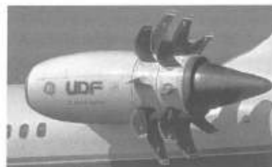
Figura 8.22. GE36 propfan en un McDonnell Douglas MD-UHB (Cortesía Burkhard Donko).
