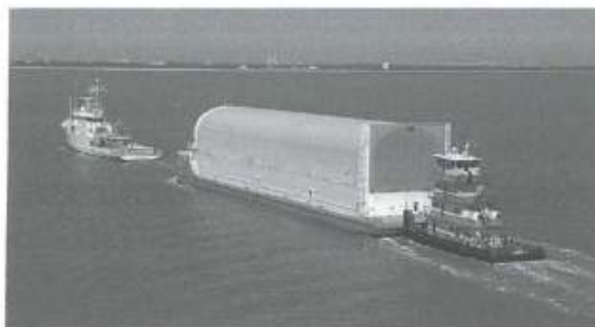
Figura 11.3. Balsa de transporte del tanque principal del Space Shuttle (fuente: NASA).
