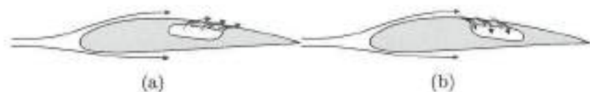
Figura 5.26. Dispositivos hipersustentadores activos. Control de la capa límite por (a) soplado o (b) aspirado.
