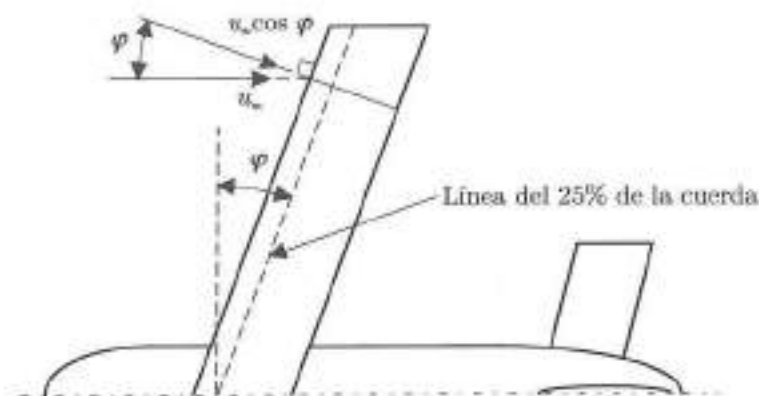
Figura 5.15. Efectos de la flecha sobre el número de Mach crítico del ala.
