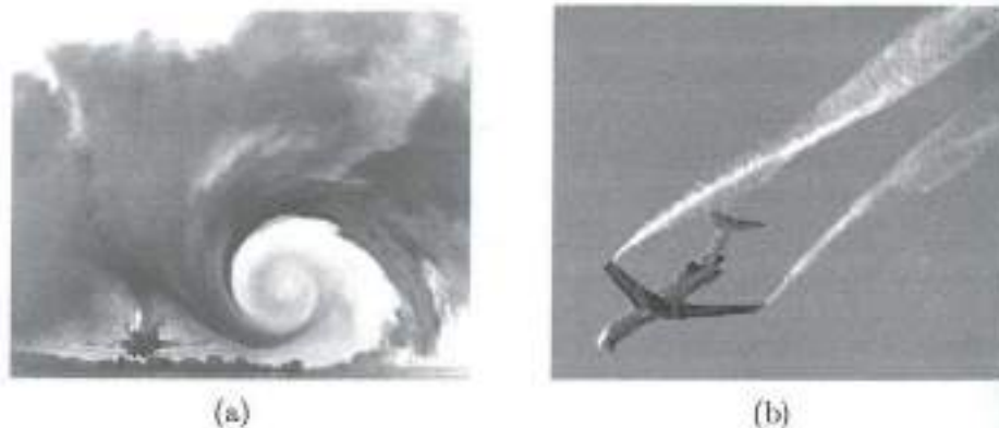
Figura 5.8. Visualización de los torbellinos mediante la inyección de humo en las cercanías de los bordes marginales del ala (fuente: NASA).
