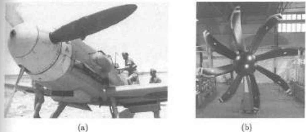
Figura 7.4. Evolución histórica de la forma de la hélice (a) años 40 Messerschmitt Me-109 (b) época actual A400-M.
