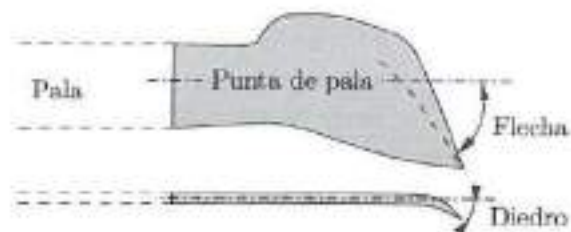
Figura 12.22. Detalle de la forma en planta y alzado de la punta de pala del helicóptero Lynx.
