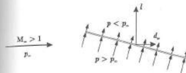
Figura 4.38. Distribución de presiones y fuerzas aerodinámicas sobre un perfil placa plana en un flujo supersónico con ángulo de ataque.
