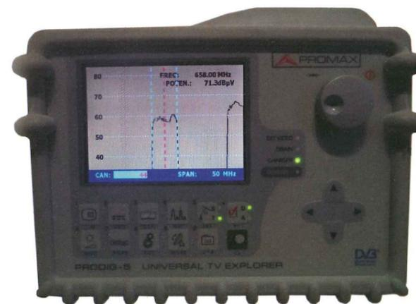
Figura 3.63. Medidor de campo.
