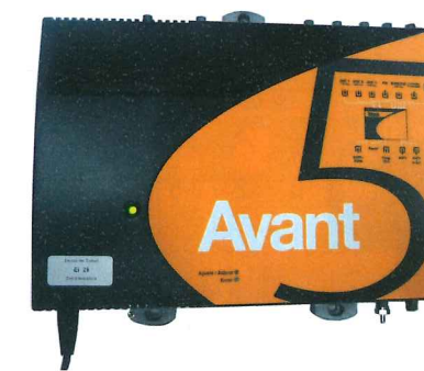
Figura 4.30. Amplificador de banda ancha.
