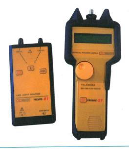
Figura 6.84. Fuente de luz y medidor de potencia.
