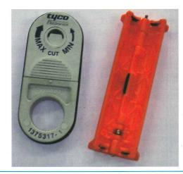
Figura 6.12. Peladora de cable.
