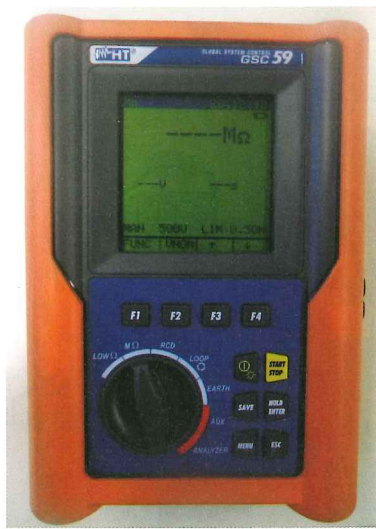
Figura 7.64. Equipo de medida con función de medidor de aislamiento.
