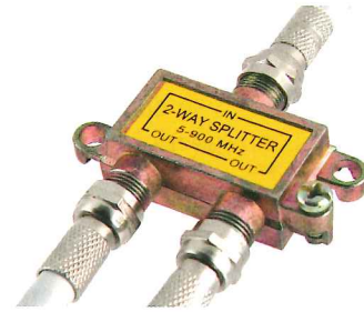
Figura 7.38. PAU de la red de cable coaxial.
