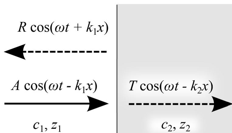
**Figura 5.7:** Transmisión y reflexión de una onda acústica de forma perpendicular a la frontera de separación entre dos medios. La onda incidente tiene amplitud  $A$ , la onda reflejada  $R$  y la transmitida  $T$ .
