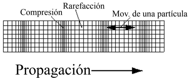
Figura 5.5: Esquema de ondas longitudinales en un sólido
