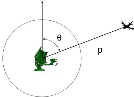
El ángulo  $\theta$  o acimut, se obtiene de la posición de la antena, mientras que la distancia  $\rho$ , se determina mediante el tiempo de
