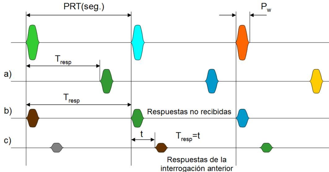
Si suponemos un radar que repite pulsos cada PRT segundos con una duración del pulso de  $P_w$  segundos, las respuestas que lleguen a la antena radar después de (PRT) no serán válidas debido a dos posibles causas:
