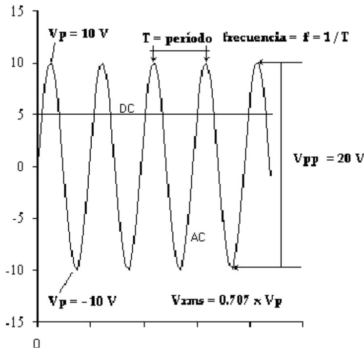
Observamos en el gráfico la representación de una tensión alterna senoidal,
