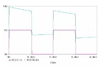
Como podemos comprobar los pulsos que llegan a la entrada del inversos en el caso del circuito con el Diodo D1 toman valores entre 0 y 5V, mientras que en el circuito sin diodo los pulsos tiene una componente de continua de casi 4V lo que hace que el tren de pulsos tome valores entre 4 y 10V, aproximadamente.
