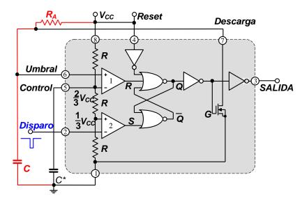
Si se sitúan los interruptores en la posición A el circuito del Astable es:
