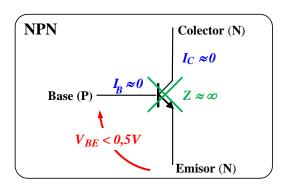
Como podemos observar funciona como si fuera un interruptor en el que la corriente que circula entre su Colector y Emisor está controlada por la tensión existente entre Base y Emisor. En el siguiente cuadro resumimos dicho funcionamiento.
