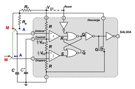
Si se sitúan los interruptores en la posición M el circuito para el Monoestable es:
