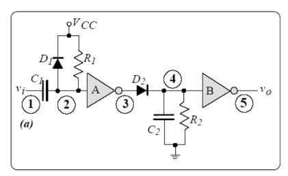
**Diodo D1:** La principal función del diodo  $D_1$  es hacer que la tensión máxima en la entrada del inversor A sea prácticamente la tensión de alimentación,  $V_{CC}$ .
