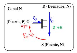
2.1.b.Si la tensión de la Puerta es menor que la tensión de Fuente ( $V_G < V_S$ , para nuestro uso en digital equivale a que en la puerta tiene un "0") el transistor pasa al corte (no se crea canal, el Drenador y la Fuente están aislados), no conduce y presenta muy alta impedancia entre dichos terminales lo que equivale a un circuito abierto.
