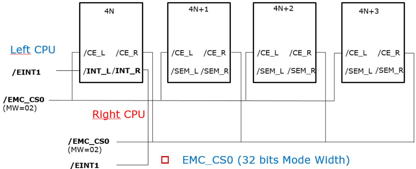
El espacio de direccionamiento del bloque de memoria de la Dual-Port de la figura, para la CPU de la izquierda y derecha es de 128kBytes (0x8000.0000 – 0x8001.FFFF).
