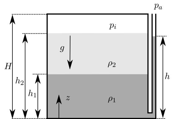
6. Debido a un gradiente vertical de concentración, la densidad de la solución salina almacenada en el depósito de la figura es función de la altura,  $\rho(z) = \rho_0 - \gamma z$ . Determine la presión  $p_0$  en el fondo del depósito.
