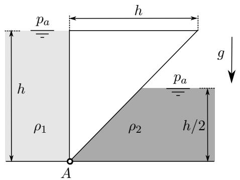
23. En el proceso de diseño de un muro que estará bajo un fluido de densidad  $\rho$  se han hecho dos propuestas, como puede verse en el dibujo. El proceso de decisión implica calcular la fuerza a la que la superficie del muro estará sometida. Si  $F_a$  y  $F_b$  son los módulos de las fuerzas a las que estarán sometidas las superficies a) y b), determine el valor del ratio  $F_a/F_b$ .
