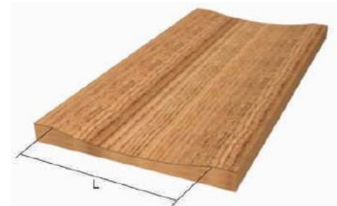
Falta de material por cepillado
