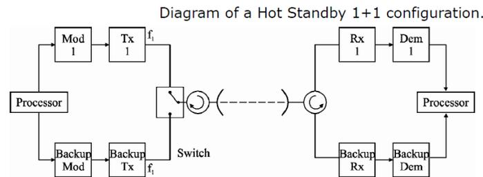
Método de redundancia en el que el sistema primario y secundario funcionan simultáneamente. De esta manera los datos contenidos son los mismos.
