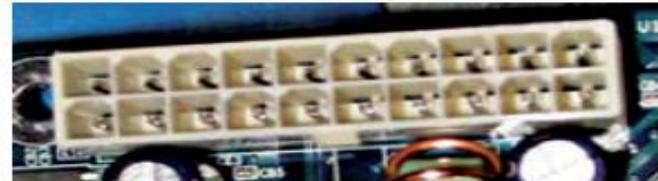
↑ Conector de corriente ATX12V.
