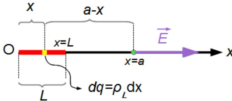
Figura 3: Línea de carga de longitud  $L$  con los parámetros necesarios para calcular el campo generado por ella
