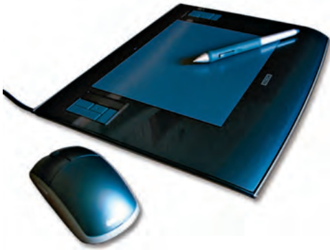
↑ Tableta gráfica con ratón especial y estilete.
