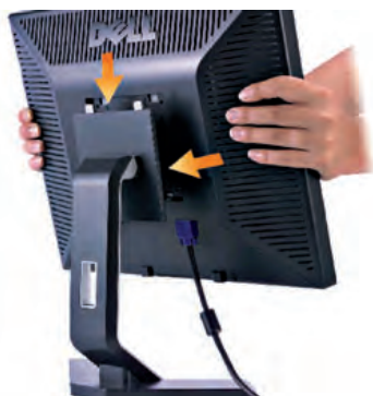
↑ Colocación de la pantalla sobre su soporte.
