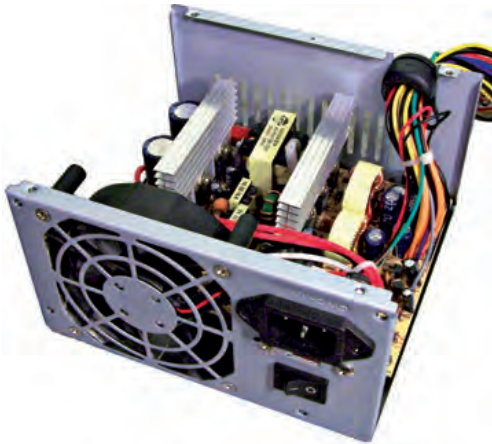
↑ Vista interna de una fuente de alimentación.
