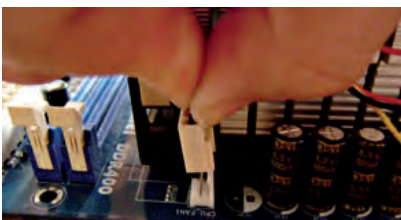
↑ Conexión de corriente del ventilador (5).
