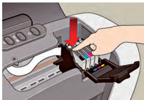
↑ Colocación de cartuchos en la impresora de inyección.
