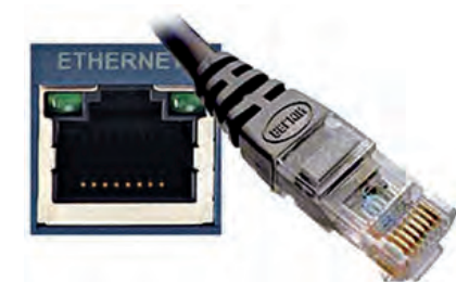
↑ Puerto y conector 8P8C (Ethernet).
