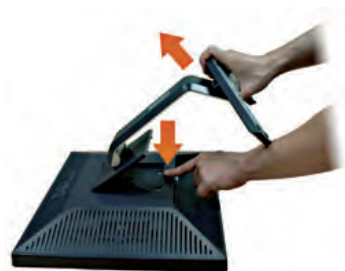
↑ Desmontaje de la base de un monitor.
