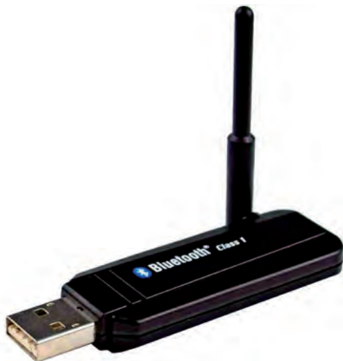
↑ Interfaz Bluetooth USB con antena.
