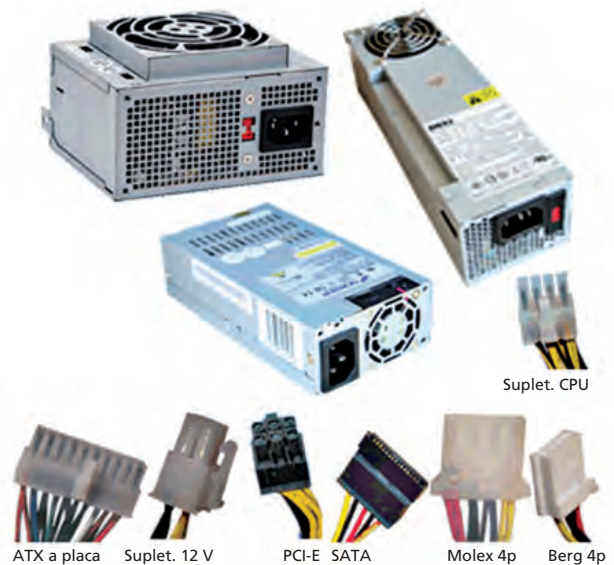
↑ Fuentes de alimentación de tamaño reducido con sus conectores.
