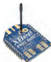
Módulo ZigBee con antena Whip.
