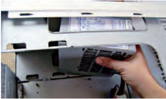
↑ Colocación de la fuente de alimentación (1).
