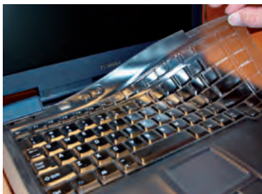
↑ Colocación de una funda protectora al teclado como medida de mantenimiento preventivo.
