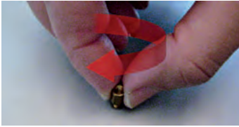
↑ Colocación de los tornillos de base (1).
