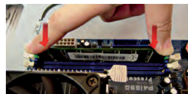
↑ Fijación del módulo en el zócalo (3).
