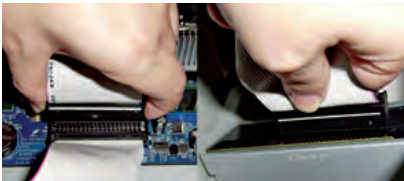
↑ Colocación del cable de datos a placa y al disco duro (7).
