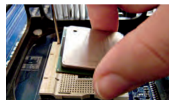
↑ Orientación y colocación del microprocesador (3 y 4).
