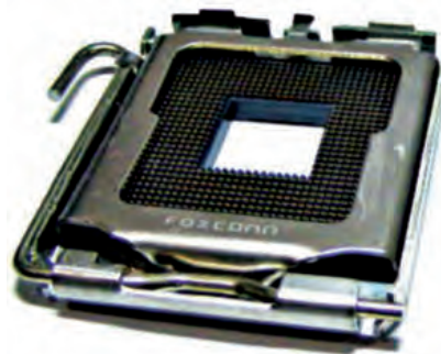
↑ Socket con sistema de conexión LGA.
