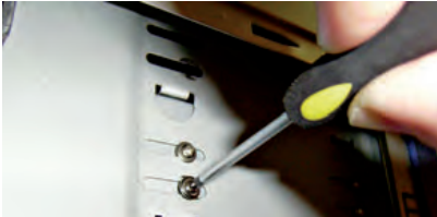
↑ Fijación de la unidad óptica a la caja (5 y 6).
