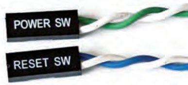
↑ Cables de encendido y reseteo a la placa base.
