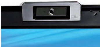
↑ Webcam integrada en la pantalla de un portátil. Puede girar sobre un eje horizontal.
