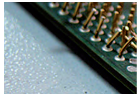
↑ Pines de un microprocesador doblados.
