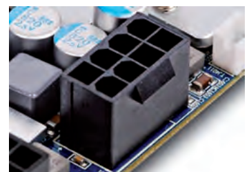
↑ Conector de corriente PEG de 8 contactos.
