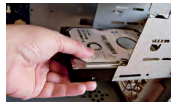
↑ Colocación del disco duro (1).
