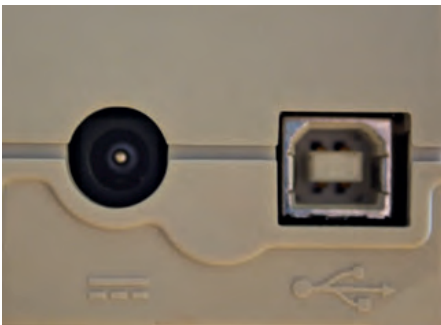
↑ Conexiones de un escáner: alimentación eléctrica y datos.
