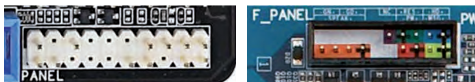
→ Varios modelos de cabecera del panel frontal.
