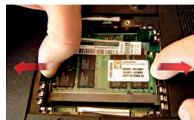
↑ Extracción del módulo de memoria.
