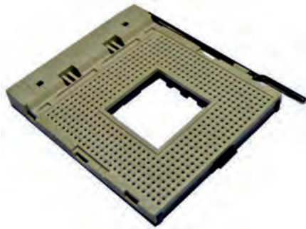
↑ Socket con sistema de conexión ZIF.
