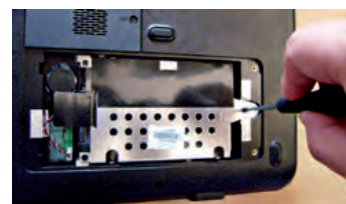
↑ Liberación de la carcasa del disco.
