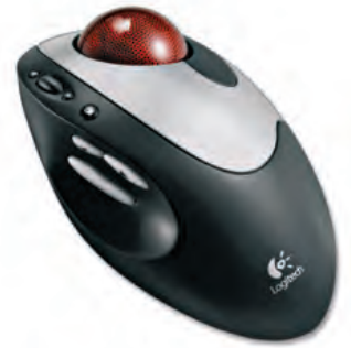
↑ Trackball con rueda y botones de función extra.
