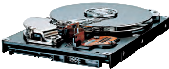
↑ Detalle de disco duro sin carcasa (cortesía de Samsung).
