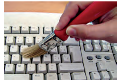
↑ Limpieza superficial del teclado con una brocha.
