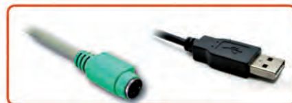
↑ Ratón con las dos conexiones más frecuentes.
