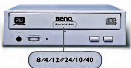
↑ Información sobre las velocidades de la unidad óptica (lector/grabador de DVD y lector/grabador de CD).
