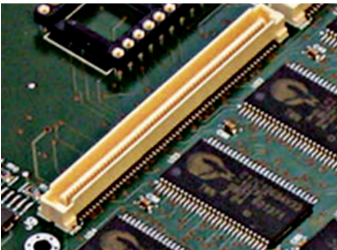
↑ Zócalo de memoria tipo Mezzanine.
