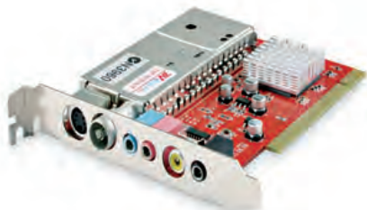
↑ Tarjeta capturadora de televisión.
