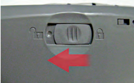
↑ Pestaña del bloqueo del carro en un escáner.
