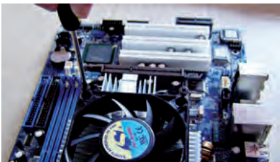
↑ Atornillado del ventilador (3).
