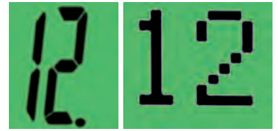
↑ Display de 7 segmentos y display de matriz 5x7.
