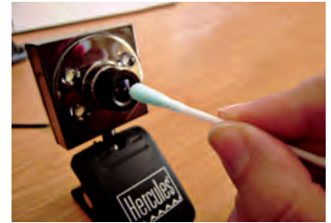
↑ Limpieza de la lente de una webcam utilizando un bastoncito impregnado en líquido limpiacristales.
