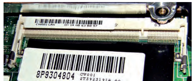
↑ Zócalo de memoria SO-DIMM de 204 contactos.
