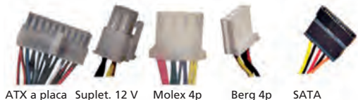
↑ Fuente de alimentación modelo ATX con sus conectores.
