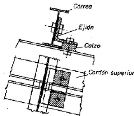
Figura 6. Apoyo de la correa en la viga
