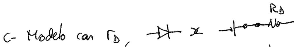
Cálculo de  $r_D$ : La tangente a la curva de características en el punto  $I_D = 18mA$  corta al eje  $V_D$  en el punto  $0.68V$ . Para nosotros, por tanto, tendríamos que la caída de tensión en la resistencia es la dada en la gráfica. Su pendiente es  $R_D$ ,  $R_D = \frac{V}{I_D} = \frac{R_D I_D}{I_D} = \frac{0.12V}{20mA}$
