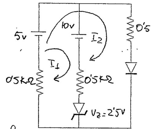
a) Partiremos de las corrientes  $I_1$  e  $I_2$  de la figura para que solamente una de ellas afecte al diodo Zener. Con esta suposición, ambos diodos conducen en directa (es poco probable que el Zener conduzca en directa, pero nos sirve de ejemplo de qué pasa cuando la suposición es incorrecta)
