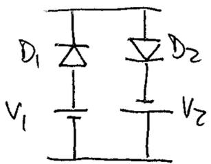
Este circuito no se puede usar. La malla formada por  $D_1$ - $D_2$ - $V_1$  y  $V_2$  tendría una corriente altísima al no haber ninguna resistencia que limite la corriente (las resistencias de los diodos en directa son muy pequeñas)
