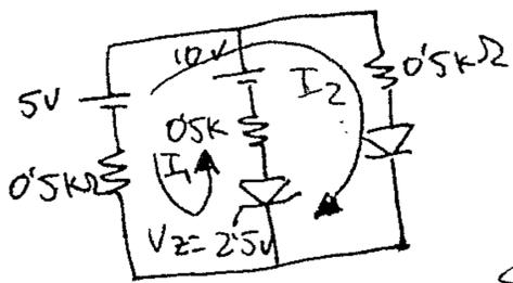
Malla 1:  $10\text{V} = 5\text{V} + 0,5\text{K}\Omega \cdot (I_1 - I_2) + V_Z + 0,5\text{K}\Omega I_1 = 7,5\text{V} + 10^3 I_1 - 500 I_2$
