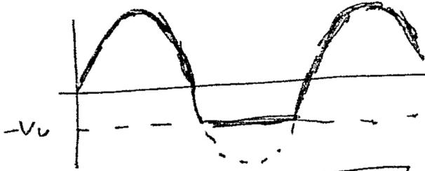
**EJEMPLO NO VÁLIDO: CORTOCIRCUITO  $V_1$ - $V_2$ - $D_1$ - $D_2$**  Forma de onda si sólo existe la rama de  $D_1$
