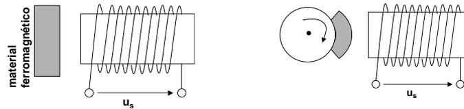
Situando en el rotor una chapa de material ferromagnético, cada vez que el rotor dé una vuelta, la inductancia de la bobina cambiará. Contando el tiempo que tarda el rotor en dar una vuelta, se podrán calcular las revoluciones por minuto a las que gira el rotor.
