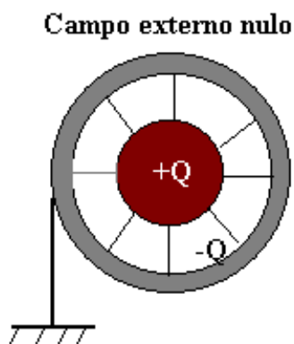
Figure 15 Esquema de un condensador esférico
