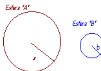
Figure 11 La esfera de radio "a" tiene una carga Q, y la de radio "b" está descargada
