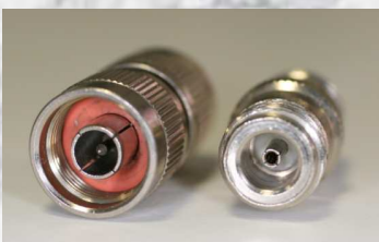
TIPO N: Macho y Hembra F_{max} : 18 GHz
