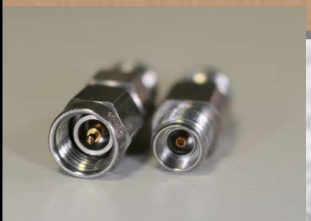
TIPO 3,5 mm: Macho y Hembra F_{max} : 26,5 GHz
