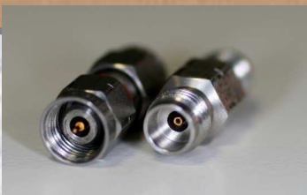
TIPO 2,4 mm: Macho y Hembra F_{max} : 50 GHz
