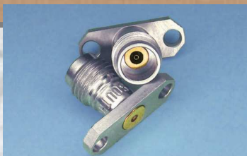
TIPO 1,85 mm: Hembra F_{max} : 65 GHz
