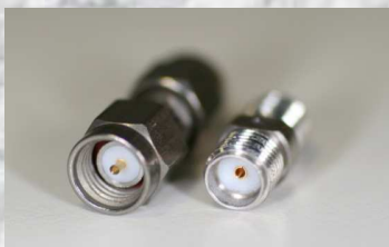
TIPO SMA: Macho y Hembra F_{max} : 18 GHz
