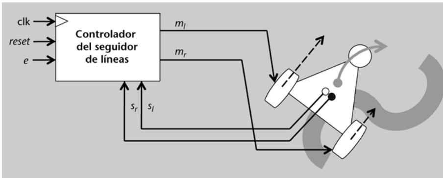
Se supone que, inicialmente, el robot se hallará en una línea y que, en el caso de que no la detecte ningún sensor, se detendrá. Con esta información, se debe elaborar el diagrama de la FSM correspondiente. (No hay que hacer el diseño del circuito que lo implemente.)
