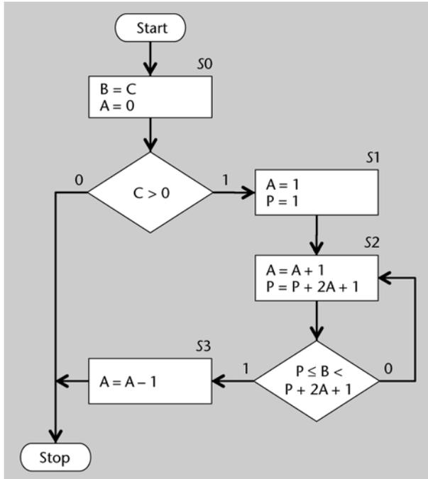
7. Se trata de ver cómo se pueden construir procesadores a partir de otros ampliando el repertorio de instrucciones. En este caso, debéis modificar el diagrama de flujo de la figura 48, que representa el comportamiento del Femtoproc, de manera que pueda trabajar con más datos que los que se pueden almacenar en los 6 registros libres que tiene. Para ello, hay que tener presente que el nuevo repertorio tiene un formato de instrucciones de 9 bits, tal y como se muestra en la tabla siguiente.
