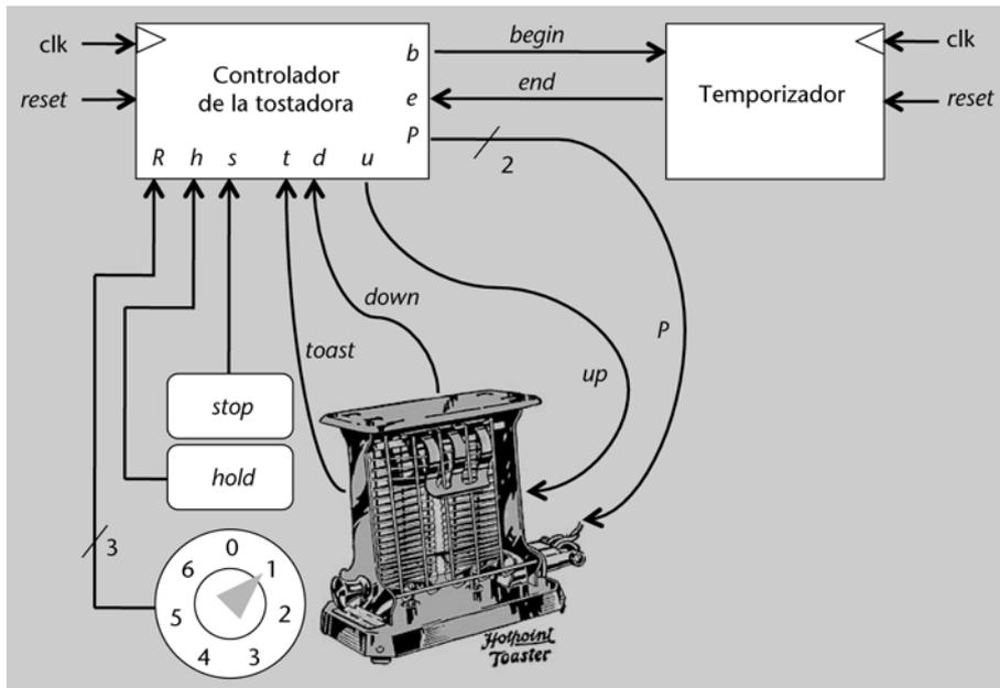
En este caso, el elevado número de entradas del controlador ayuda a mostrar las ventajas de la representación de su comportamiento con una ASM. En la figura 31 se puede observar el diagrama completo.
