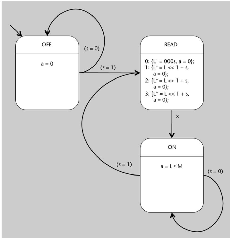
De cara a la implementación en un circuito, habría que codificar los tres estados, de manera que OFF fuera 00 y, a modo de ejemplo, READ pudiera ser 01 y ON, 10. También habría que tener un contador interno de dos bits activado con una señal interna, *inc*, que se debería poner a 1 para los valores 0, 1 y 2 del estado-programa READ. La señal de salida *a* depende exclusivamente del estado en el que se encuentra la PSM:
