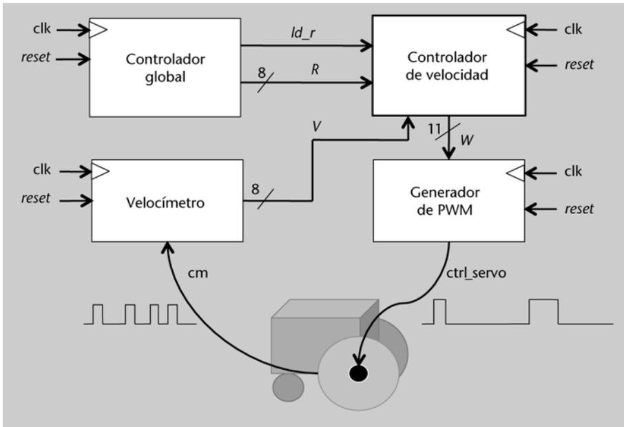
La relación no lineal entre velocidad y ancho de pulso se almacena en una memoria ROM del controlador de velocidad. En esta memoria se almacenarán los puntos de la función que relaciona el ancho de pulso con la velocidad de rotación, tal como se muestra en la figura 20. Así, dada una velocidad tomada como dirección de la memoria, se obtiene el ancho de pulso correspondiente, tomado del contenido de la posición correspondiente.
