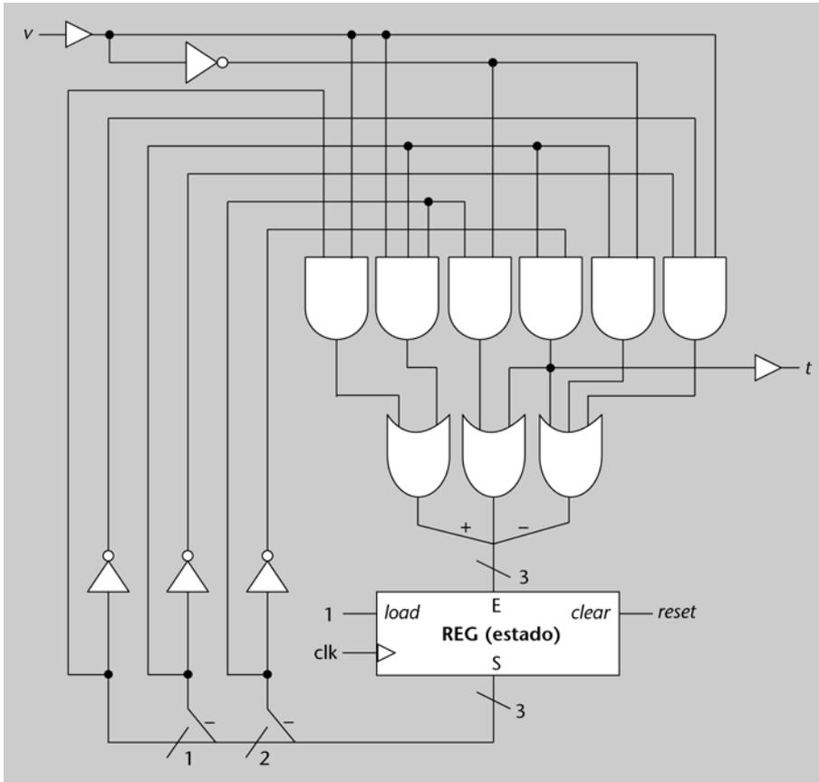
En este caso, se ha optado por hacerlo con puertas lógicas (se deja, como ejercicio, la comprobación de que el circuito de la figura 6 se corresponde con las funciones lógicas de las tablas de transición y de salida del controlador).
