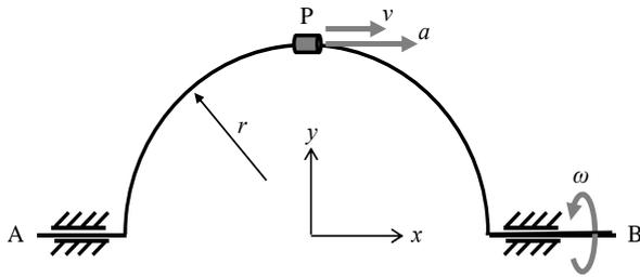
22.- En el instante que se muestra en la figura el collarín  $P$  se mueve con una velocidad  $v$  y una componente  $x$  de la aceleración  $a$  relativas a una barra semicircular  $AB$ , tal y como se indica en la figura. A su vez, la barra  $AB$  rota con velocidad angular  $\omega$  constante alrededor del eje  $x$  en sentido positivo. Determine el vector de aceleración absoluta del collarín  $P$ .
