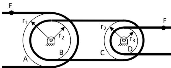
6. El sistema mostrado en la figura se denomina reductor. Está formado por dos poleas dobles AB y CD de tal forma que tanto A y B como C y D están unidas rígidamente entre sí. Determinar el vector velocidad del punto F si se conoce la velocidad del punto E ( $v_E$ ).
