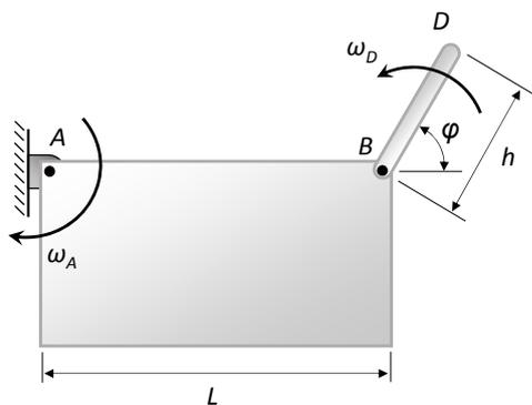
12.- La placa de la figura rota alrededor de  $A$  con una velocidad angular constante  $\omega_A$ . Simultáneamente, la varilla  $BD$  gira alrededor de  $B$  con una velocidad angular constante  $\omega_D$  respecto a la placa. Demuestre que si  $\omega_D = 2\omega_A$ , la aceleración del punto  $D$  tiene sentido hacia el punto  $A$  y que es independiente de  $L$ ,  $h$  y  $\varphi$ .
