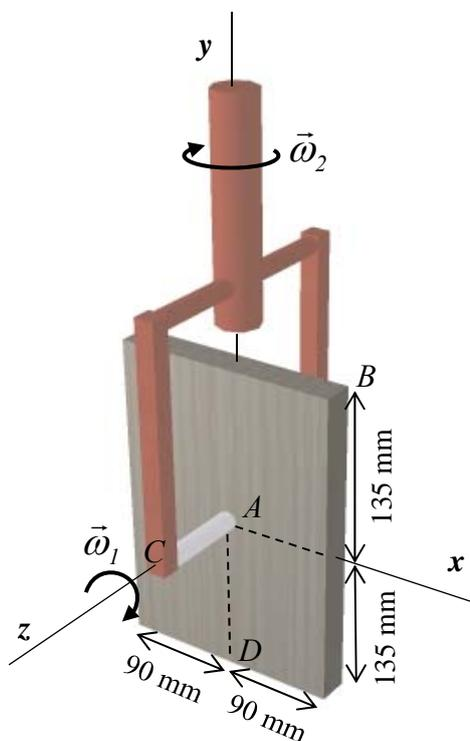
20. (c) - La placa rectangular que se muestra en la figura está unida a la barra AC por un pasador en el punto A. Esta placa se encuentra girando con una velocidad angular constante  $\omega_1 = 8 \text{ rad/s}$  sobre eje AC. A su vez todo el sistema gira a razón constante  $\omega_2 = 10 \text{ rad/s}$  sobre el eje y. En el instante mostrado, determine la velocidad y la aceleración de los siguientes puntos de la placa:
