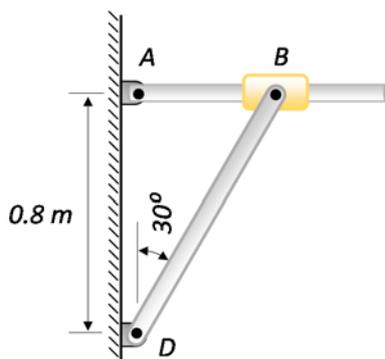
14.- En el instante mostrado en la figura, la varilla unida a  $A$  rota con velocidad angular constante  $\omega_A$  de  $0.76 \text{ rad/s}$  en el sentido contrario a las agujas del reloj. Determine la velocidad angular y la aceleración angular de la barra  $DB$ .
