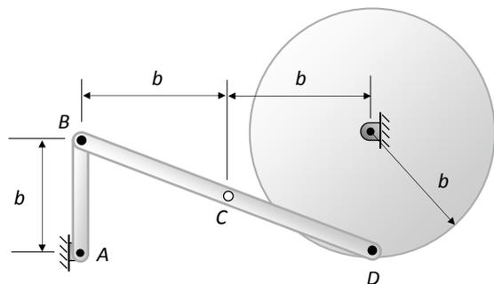
10. (c) - En el instante que muestra la figura la barra  $AB$  tiene una velocidad angular  $\omega_{AB}$  en el sentido horario y aceleración angular nula. Determine:
