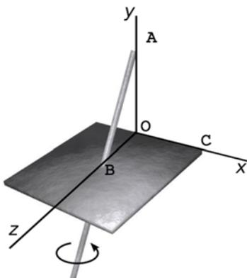
1.- La placa rectangular de la figura, cuyos lados miden 60 cm, está soldada a un eje fijo que pasa por un punto A a una altura de 40 cm del origen y por el centro de la placa (punto B). La placa rota alrededor del eje AB con una velocidad angular constante de 25 rad/s en el sentido mostrado en la figura. Si en el instante mostrado la placa está justo en el plano xz, encuentre la velocidad y la aceleración del punto C.
