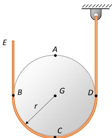
8. (c)- El cilindro de radio  $r$  de la figura rueda sobre la cuerda. Si en el instante mostrado el punto  $E$  de la cuerda tiene una velocidad  $v_0$  y una aceleración  $a_0$ , ambas hacia arriba, determine las aceleraciones de los puntos  $A, B, C$  y  $D$ .
