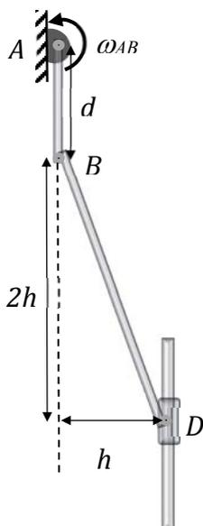
4.- El brazo AB tiene una velocidad angular constante  $\omega_{AB}$  en sentido contrario al de las agujas del reloj. En el instante mostrado en la figura, determine el vector velocidad del punto D y la velocidad angular de la barra BD
