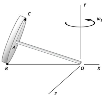
17.- Sobre un eje OA de 10 cm de longitud se monta un disco de 3 cm de radio de modo que el eje es perpendicular al plano del disco. El punto O del eje es un punto fijo mientras que el disco rueda sin deslizar sobre el suelo a una velocidad constante  $\omega_1 = 2.4$  rad/s tal y como se indica en la figura. Determine:
