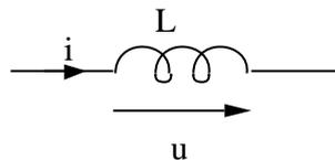
Figura 2.10. Bobina con referencia de potencia entrante
