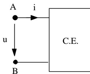
Figura 1.3 Dipolo con referencias de potencia entrante.
