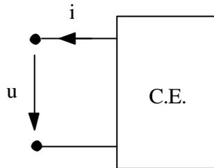
Figura 1.4. Dipolo con referencias de potencia saliente.
