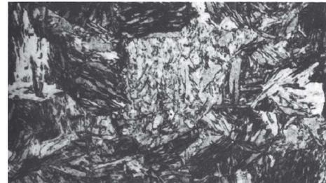
Microestructura acicular o en forma de agujas de la martensita
