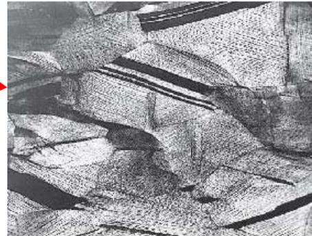
(a) Un latón con acritud (deformado a través de unos rodillos de tal manera que se reduce su sección transversal en un tercio),
