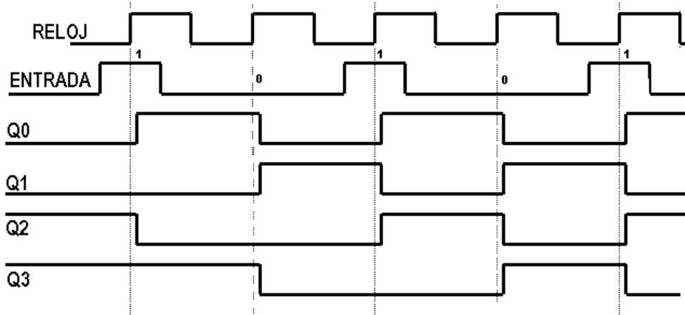
**U3\_2.** En el sistema secuencial de la figura, se supone que inicialmente  $Q_0 = Q_3 = 1$ ,  $Q_1 = Q_2 = 0$ . Dibuje en un diagrama de tiempos las señales de salida de los flip-flops 0, 1, 2 y 3 durante cinco ciclos de reloj.
