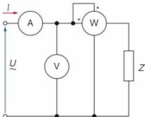
1. Se ha medido la potencia de un motor monofásico utilizando el circuito de la figura. El vatímetro ha indicado 540 W, el amperímetro 4 A y el voltímetro 230V. Calcular las potencias activa, reactiva y aparente del motor y su factor de potencia.
