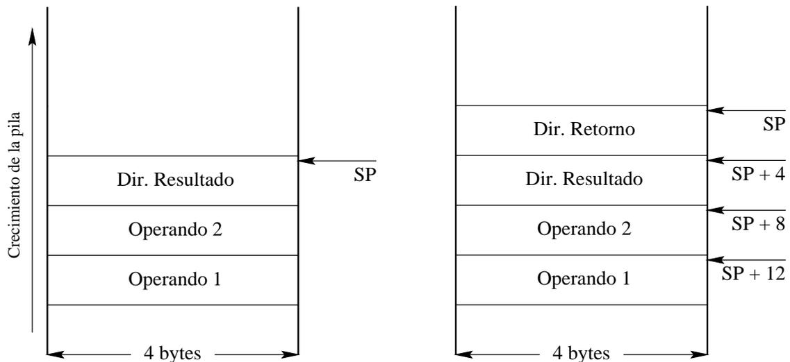
Figura 4: Estado de la pila antes y después de ejecutar la instrucción CALL
