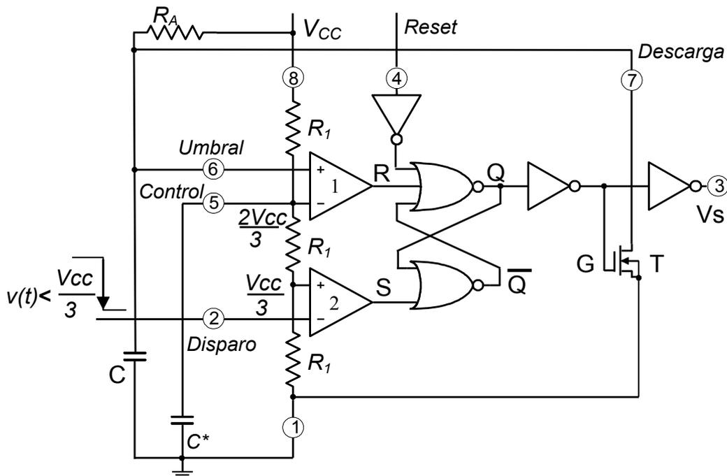
A)  $S=0, R=1, Q=0, G=1, V_s=0$ , el transistor T conduce y el condensador, C, se mantiene descargado.
