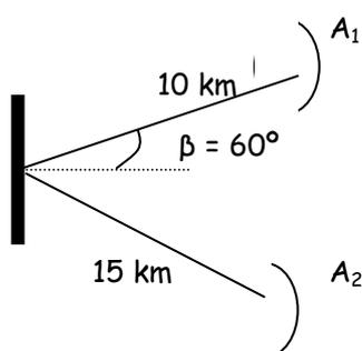
Las ganancias de las antenas parabólicas terminales son de 35 dB cada una de ellas. Las pérdidas en los terminales de los equipos y alimentadores de antena del transmisor y del receptor son de 0,5 y 0,7 dB, respectivamente, y el rendimiento del reflector es del 60%.
